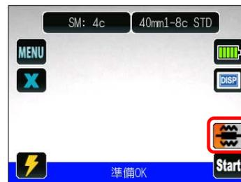
5. ヒータアイコン(🔥)を押して保護スリーブの加熱補強を開始します。
