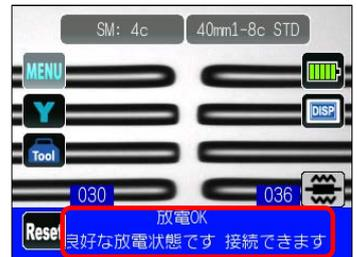
3. 「良好な放電状態です 接続できます」が表示されたら、再度ファイバ前処理を行い、融着接続工程へ進みます。※放電テストではファイバは接続されません。
