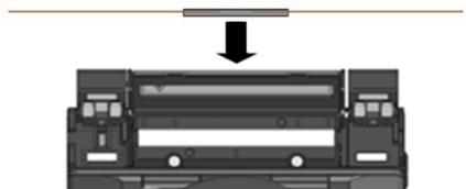
4. 融着機からファイバを取り出し、保護スリーブを接続箇所左右均等になるように挿入し補強器にセットします。
